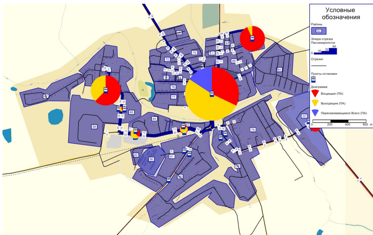
Рисунок 1.23 — Результат перераспределения макромодел пассажиры ОТ (по отрезкам модели приведены относительные нагрузки по проезжающим пассажирам в обе стороны (по толщине линий); на остановках - круговые диаграммы, площадь которых соответствует пассажиропотоку по остановке, красным цветом доля входящих, желтым выходящих, синим пересаживающихся пассажиров)
